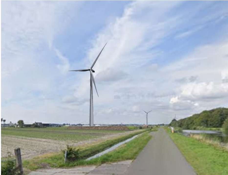
Deze visualisatie toont windturbines met tiphoogte 350 meter en vermogen van 12,5 MW om de 3,5 kilometer in het landschap. Beeld Marc van Grieken, MVGLA met windplanner software. (Zie ook pagina 9)
